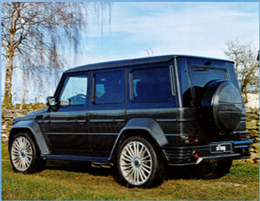
1.5リットルのエンジンがパンパニアでカーボン化された。スクエアなボディが全面的にカーボンに置き換えられたその姿は、まさに異形。
