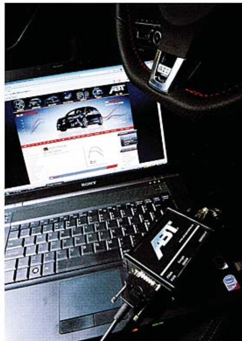
↑車両側のOBD2ポートとパソコンを専用のケーブルでつなぎ、プログラムをABTへ送信。その後変更されたプログラムを再インストールすれば終了。1時間足らずで作業は終了する
