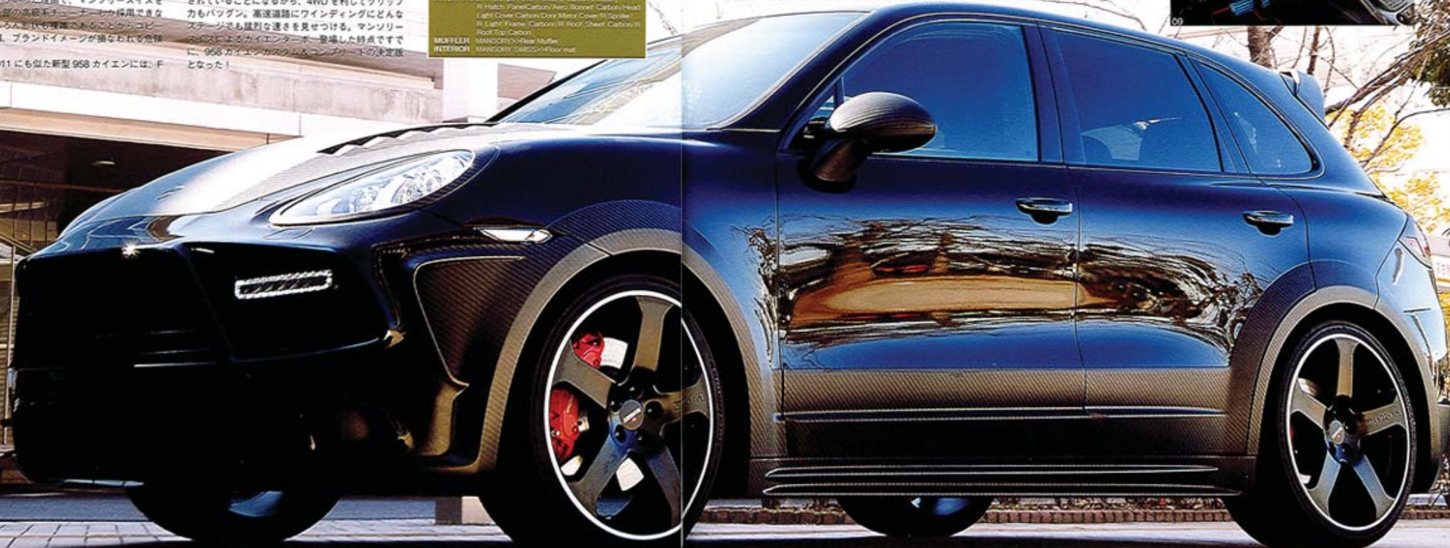
01 フロントマスクからサイドミラーに渡るフレッドファンダー。カーボンのアレンジが施される。ホイールはマンソリーの専用設計。フロントブリックはホイールのアタックラインでカスタム。02 ボンネットはドライカーボン製。またヘッドライトリムなどアドオンパーツは強力なドライカーボンとして重量への配慮は万全。03 リア側のフレッドファンダー後方にはダクトが設けられ、リアバンパーのデザインとの流れがわかる。このあたりのデザインはさすが。04 サイドミラーはカーボン製のもののようにも見える。05 マフラーは直線4本出しでチップレスのエアフロー。パターニングなど同じく高性能がコンセプトの部品は、流体力学のカンニングフューザーが施される。06 ノーズスポイラーもドライカーボン製。デザインも凝っている。07 タイヤはコンチネンタルのクロスコンタクトUHP。フロント側にも295/30という猛烈なサイズがマウントされる。08 ボンネット裏をのぞく。ドライカーボンが施される。09 新型カイエンターボのコアゼット。コアゼットはマンソリースイス製だ。
