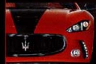
エクステリアに走るLEDライトが、新しい表情をもたらしている。カーボン製パーツをふんだんに盛り込み、リヤスピーカー、ディフューザーなども装着される。タイヤサイズはフロント255/30ZR20、リヤは305/28ZR21。
