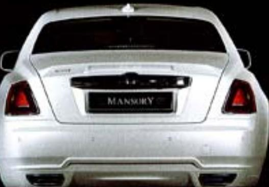
トヨタ・一体型リヤバンパー、サイドスカート、トランクスボイラードなどは意外と控えめ。「豪華」と「堅り」という相反するイメージを上手くバランスさせているのは、マンソリーならではの技術と言える。6.6LV12ツインターボエンジンは、ターボチャージャーを大型化し、ECUを書き換へ、エキゾーストを変更。最大出力はノーマルの563hpからア20hpまでパワーアップされている。最大トルクも780Nmから860Nmと向上。0-100km/h加速は4.8秒から4.4秒へ短縮され、2.4t近い車重を考えれば十分すぎる加速性能だ。
