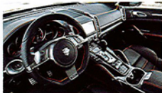
ステアリングは、スポーツタイプの形状を採用したフラットボトムタイプ のオリジナル品に交換される。
